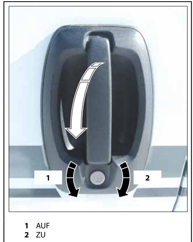
Abb. 15 Fahrerkabinentür von außen öffnen und schließen
