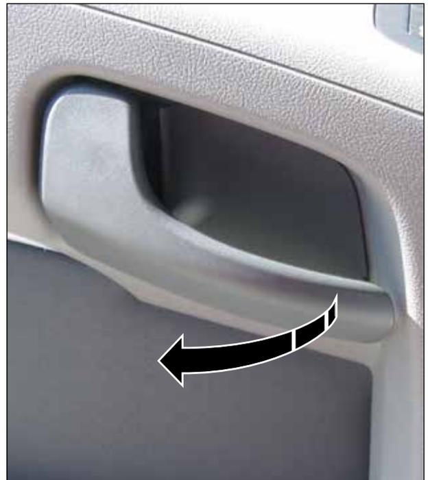
Abb. 16 Tür von innen öffnen und schließen
