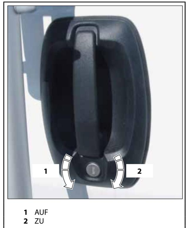
Abb. 19 Ersten Flügel der Zweiflügel-Hecktür von außen öffnen und schließen
