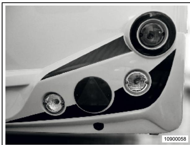
Abb. 87 Lampenwechsel am Heckleuchtenträger
