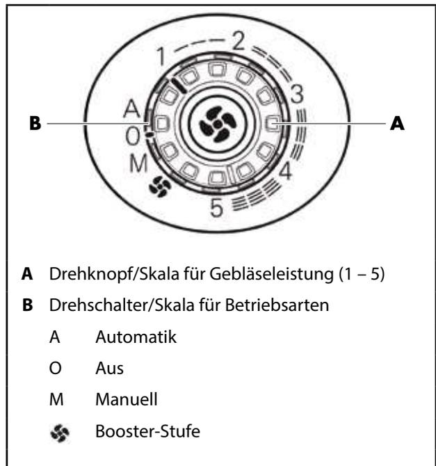
Abb. 67 Bedienteil internes Umluftgebläse 12-Volt-Ausführung
