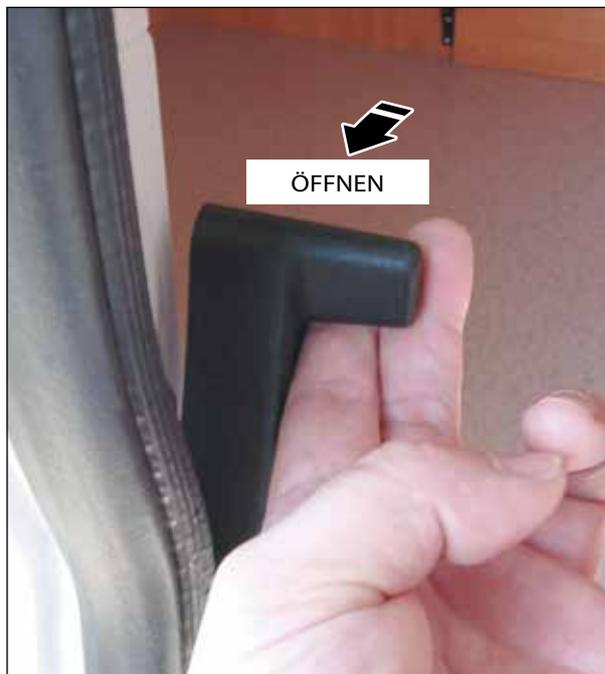
Abb. 21 Zweiten Flügel der Zweiflügel-Hecktür von innen öffnen und schließen
