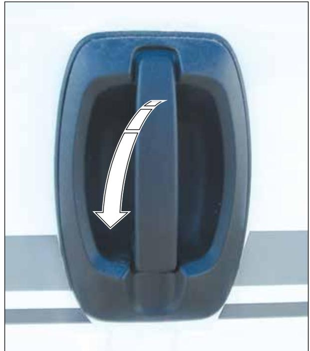
Abb. 17 Schiebetür von außen öffnen und schließen
